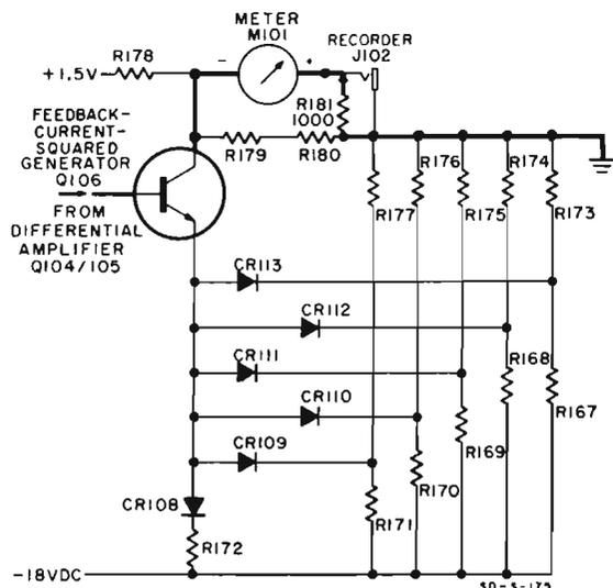
Figure 4-8. Meter Circuit
