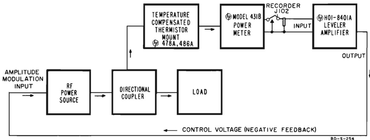
Figure 3-6. Leveler Setup
